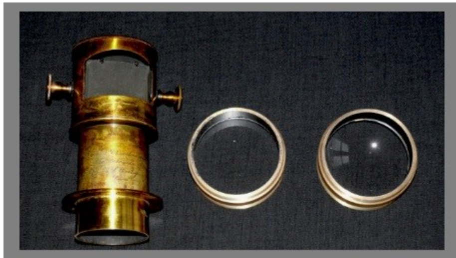
Objectif de 5 pouces français ( p = 2,7 cm) utilisé par Niépce soit 135 mm avec deux lentilles ouvertes à F/4
